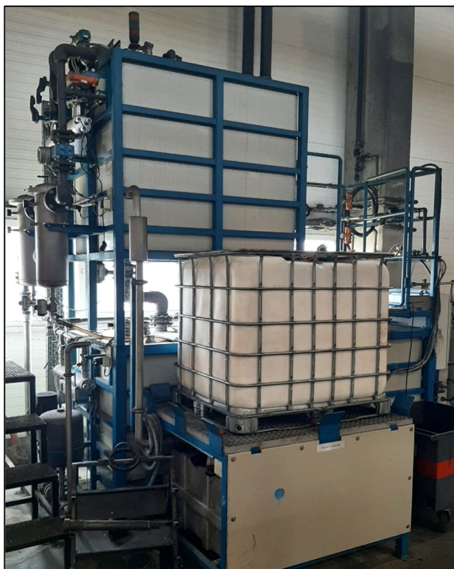
2. kép Formaleválasztó központi keverő, ellátó egység
