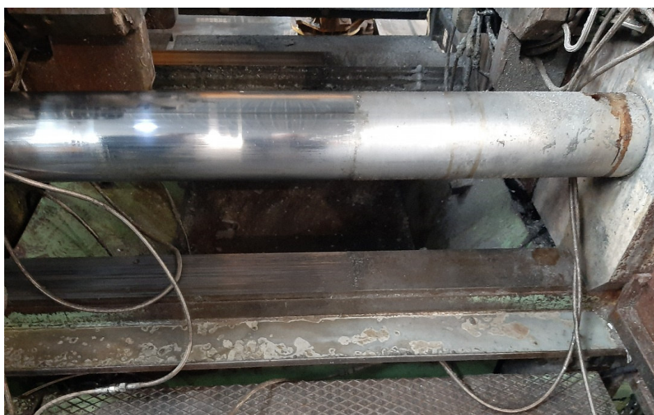
3. kép Formaleválasztó gyűjtőtálca a nyitott szerszám alatt
