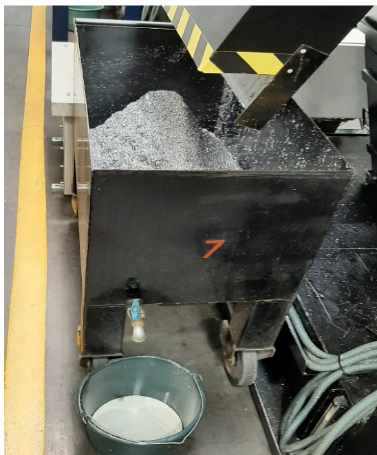
1. kép Forgácsgyűjtő, emulzió leválasztással
